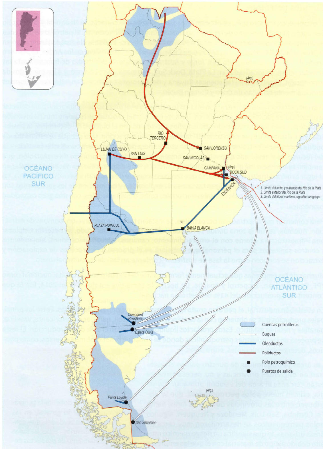
Cuencas petroleras argentinas actualmente en explotación, canales de transporte existentes tanto para el petróleo crudo como sus derivados y provincias que cuentan con polos petroquímicos
